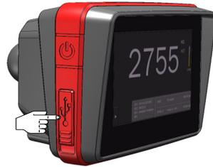
Nach Speicherung der Wiegedaten, stecken Sie den USB-Stick in die Anzeige.
