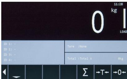
2. Um einen Wiegezyklus durchzuführen, nehmen Sie die Last auf und heben Sie diese mit konstanter Geschwindigkeit an, solange der gelbe Pfeil weiter nach oben blinkt.
