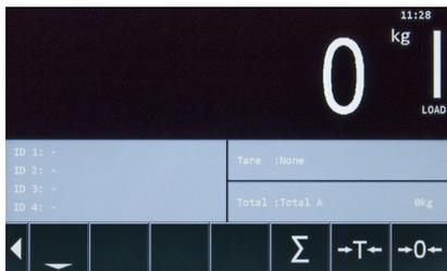
8. Wenn das Gewicht in Rot angezeigt wird, war die Wiegung nicht korrekt. Wenn der Indikator keine Null anzeigt, muss eine neue manuelle Nullstellung durchgeführt werden. Siehe 3.4.2.
