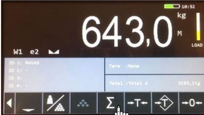
Nachdem die Wiegung abgeschlossen ist, drücken Sie die  $\rightarrow\Sigma\leftarrow$  Taste, um alle Daten auf dem Indikator zu speichern.
