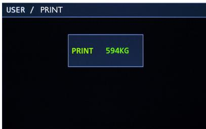
4. Das Gewicht wird gedruckt und die Anzeige ist bereit für die nächste Wiegung.
