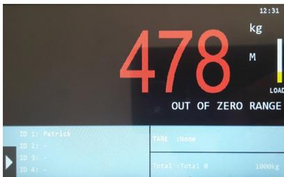
8. **Überlast.** Der Gabelstapler ist laut Lastdiagramm überlastet.
