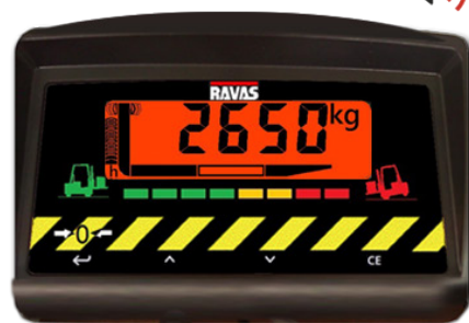
Sytuacja niebezpieczna. Przeciążenie: zbyt ciężki ładunek
