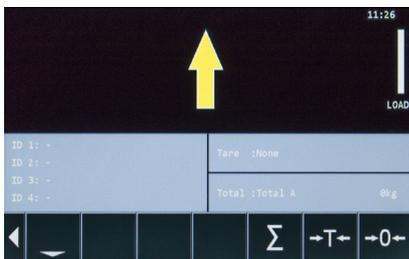
4. Eleve las horquillas vacías con una velocidad constante hasta que la flecha amarilla que está parpadeando en la pantalla le muestre que tiene que bajar las horquillas.
