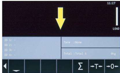
7. El indicador muestra el peso después de completar la comprobación del punto cero.
