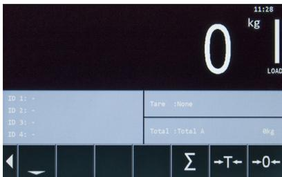
2. Para realizar un ciclo de pesaje, coja una carga y elévela a una velocidad constante durante el tiempo que la flecha amarilla esté parpadeando en dirección ascendente. Si la flecha cambia a la dirección opuesta, baje las horquillas hasta que el peso aparezca en la pantalla. Para una explicación detallada, véase: 3.4.1 pasos 3-6
