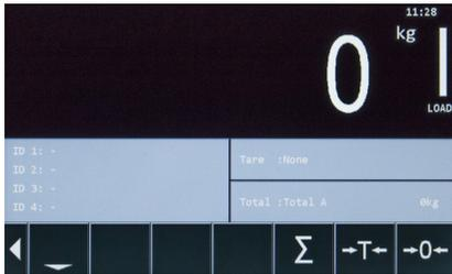
8. Si el peso está rojo, el pesaje no habrá sido correcto. Si el indicador no muestra cero, se deberá ajustar manualmente un nuevo punto cero. Véase: 3.4.2
