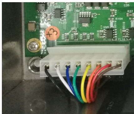
Abbildung 4-2: Stiftpositionen des integrierten Spannungsmoduls
