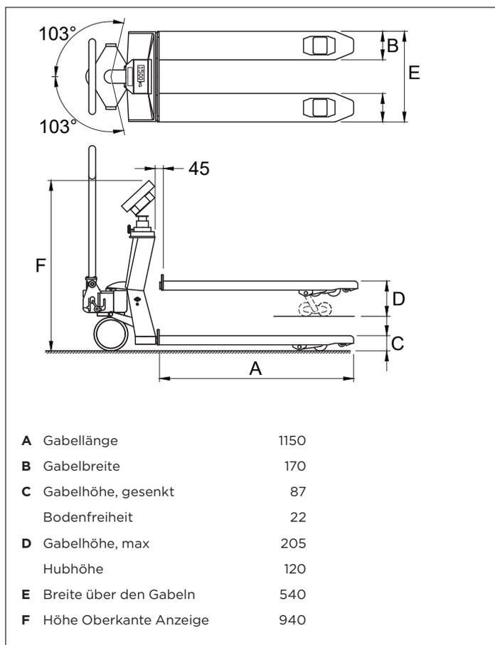
Für geeichte Ausführung, Handelsklasse OIML III : Europäische Zulassung Nr. T2782, Abschaltung der Anzeige bei Schiefstand ab 2°. Anzeigeschritt Mehrbereichsanzeige 0,5/1 kg, oder ein von den folgenden festen Anzeigeschritten:
