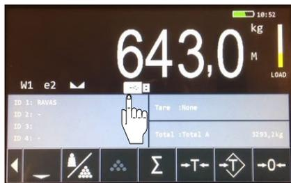
Se la connessione è stata effettuata, l'immagine della chiavetta USB è visibile sul display.
