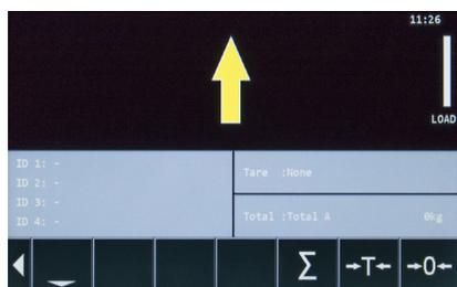
4. Sollevare le forche vuote con una velocità costante fino a quando la freccia gialla lampeggiante sul display indica di abbassare le forche.
