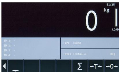
8. Se il peso è rosso, la pesatura non è corretta. Nel caso in cui l'indicatore non mostra zero, occorre impostare un nuovo zero manualmente. Vedere paragrafo: 3.4.2.
