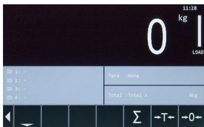
2. Per eseguire una pesatura, prendere il peso e sollevarlo con velocità costante finché la freccia gialla continua a lampeggiare verso l'alto. Se la freccia gira nella direzione opposta, abbassare le forche fino a quando il peso appare sul display.
