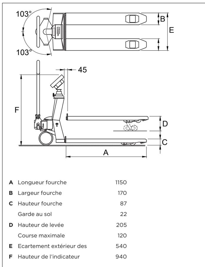
Pour version homologuée en transactions commerciales, classe OIML III, approbation européenne n° T2782, coupure automatique de l'affichage si inclinaison supérieure à 2°. Graduation: multi-échelon 0,5/1 kg, ou l'une des graduations fixes suivantes :
