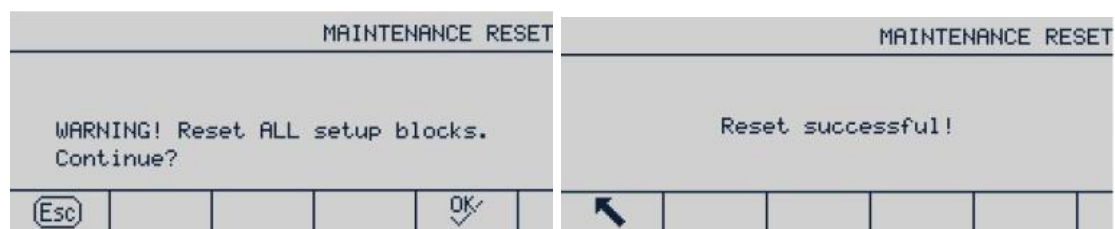
Figura 3-93: Telas de Reinicialização de Manutenção
