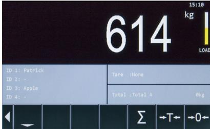
Durch drücken von '<' können diese ausgeblendet werden. Beim nächsten Einschalten der Anzeige, sind sie wieder sichtbar. Führen Sie folgende Schritte aus, wenn Sie die Schaltflächen immer ausblenden möchten.
