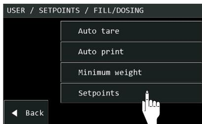
Um die Start- und Stoppfunktion der Befüllung/Dosierung zu automatisieren, können Sie verschiedene Werte einstellen. Z.B. die Sollwerte (Setpoints).
