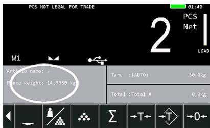
Automatisch wird das Gewicht pro Stück berechnet (siehe Display links).
