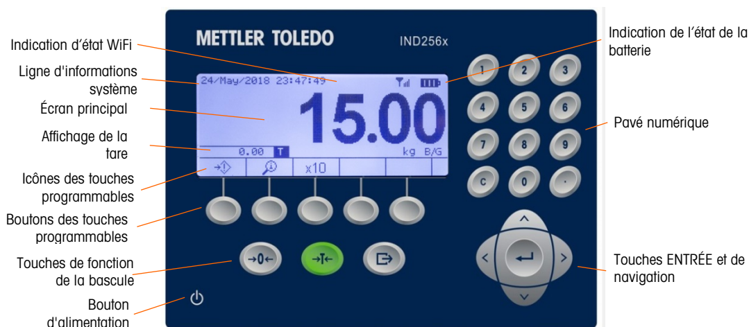
Figure 2-3 : Affichage et clavier de l'IND256x
