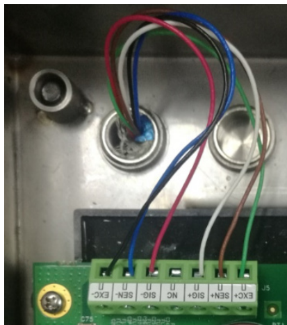
Figure 4-3 : Borne de connexion d'un capteur analogique
