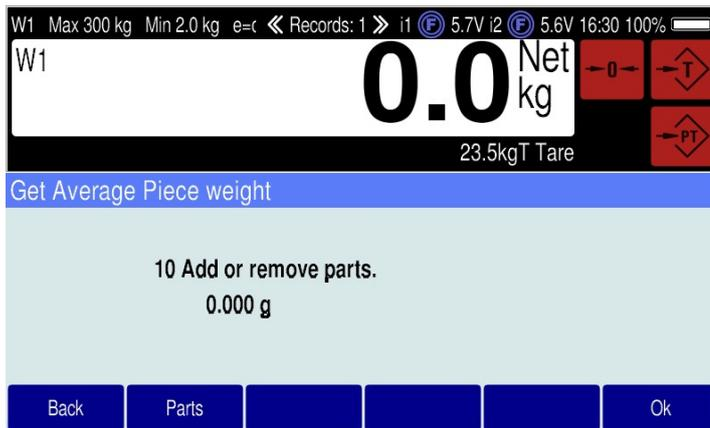
Ermittlung des mittleren Stückgewichtes durch auflegen/Entfernen einer Menge von Teilen.
