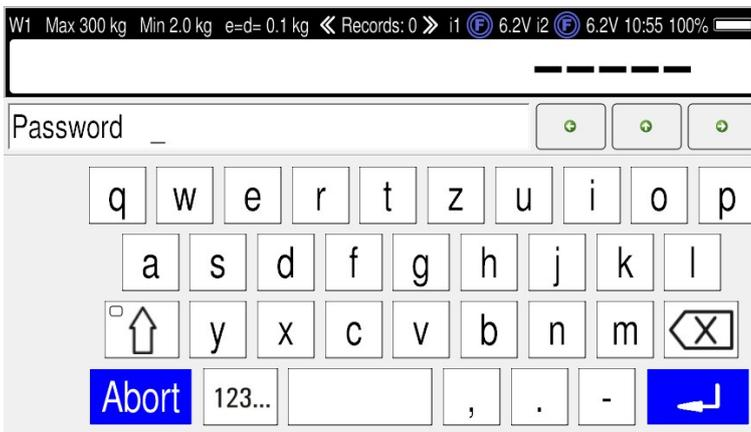
Über die Taste '123' kann auf die numerische Belegung zurückgeschaltet werden.
