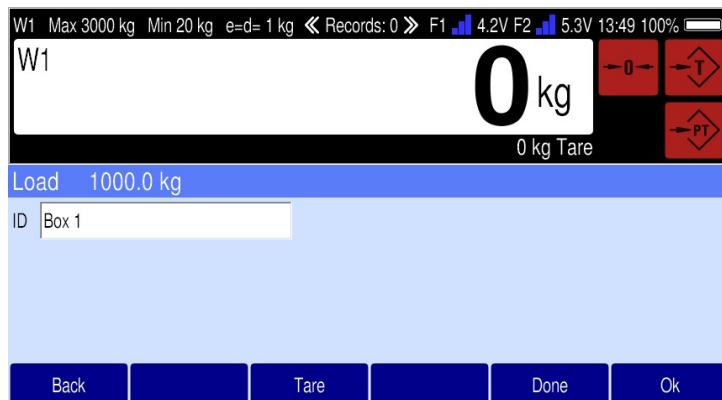
Inserimento ID e inizio pesatura o termine pesatura.
