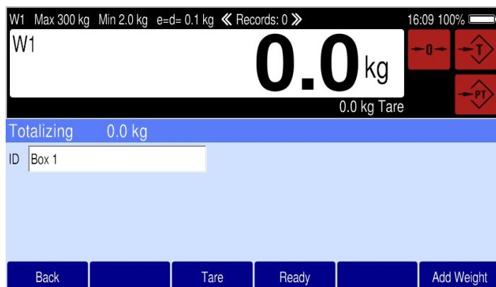
Inserimento ID e inizio pesatura o termine pesatura.
