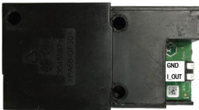
Figura 2-14: Tarjeta opcional de salida analógica intrínsecamente segura
