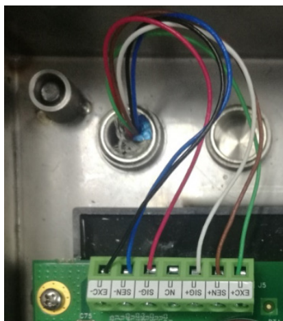
Figura 4-3: Terminal de conexión de celda de carga analógica
