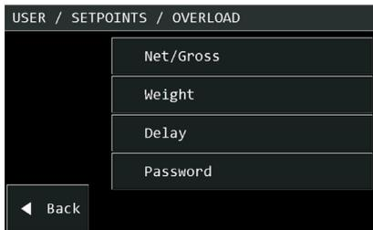
Para configurar as condições para a opção da demora seleccione "Delay".
