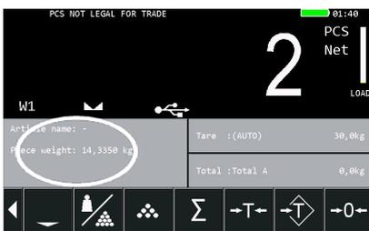
O peso por peça é calculado automaticamente (ver no visor à esquerda).
