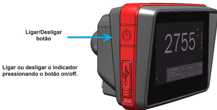
Após 5 segundos, os componentes eletrônicos já aqueceram e pode iniciar a pesagem.
