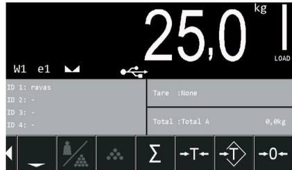
O indicador volta ao modo de pesagem e está pronto para a próxima pesagem. O símbolo NET desapareceu. No campo da tara, "None" está ativo.
