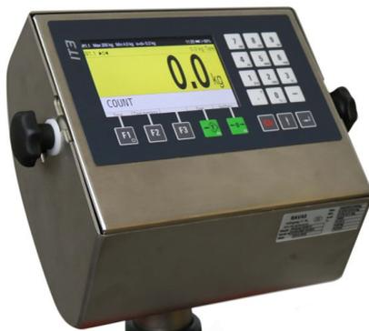
Após 5 segundos, os componentes eletrônicos já aqueceram e pode iniciar a pesagem.
